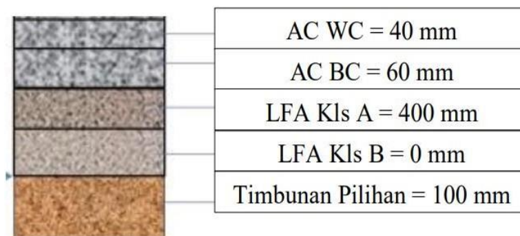
Gambar 2. Detail tebal perencanaan perkerasan lentur.
