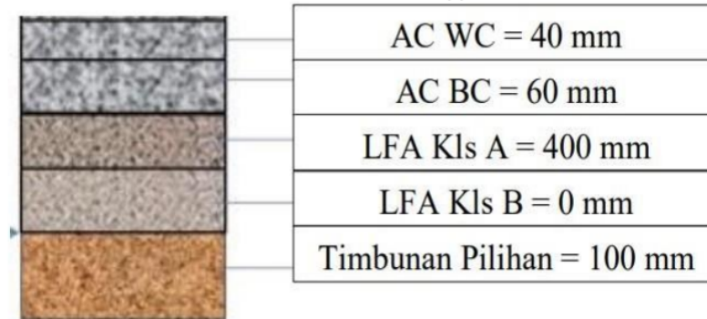
Gambar 2. Detail tebal perencanaan perkerasan lentur.
